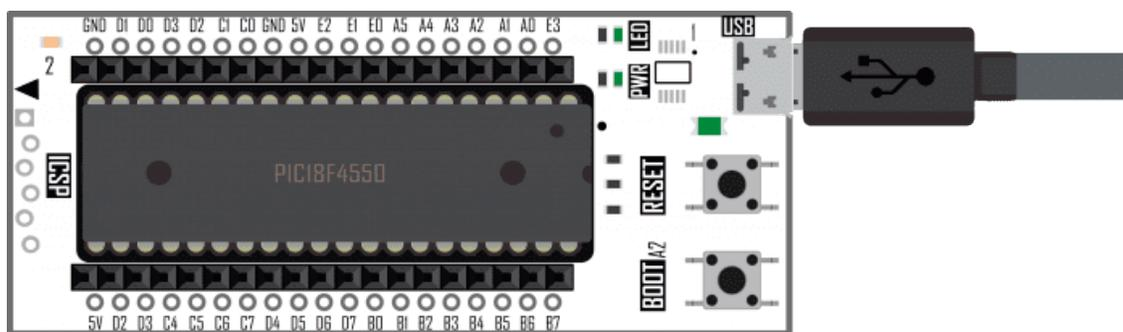
► Programación por medio del puerto ICSP con un programador externo
