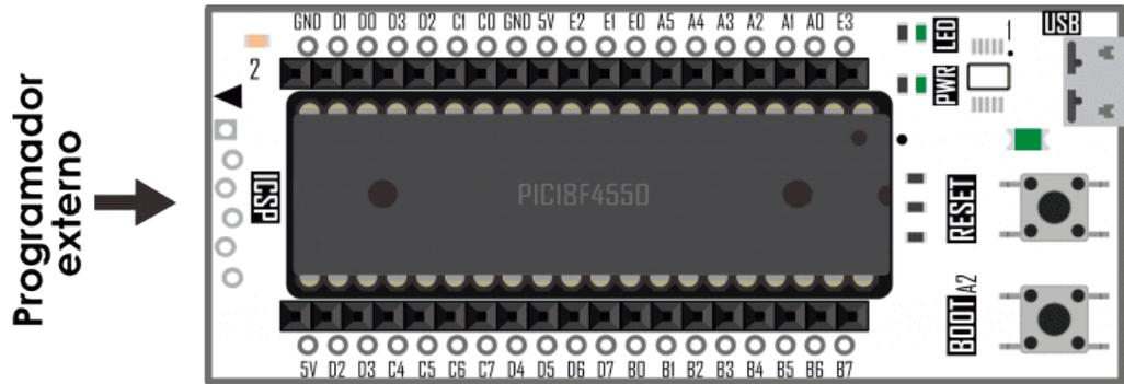
**Nota:** Si se usa un programador externo por medio del puerto ICSP se borrará el bootloader precargado y será necesario adquirir un nuevo PIC.
